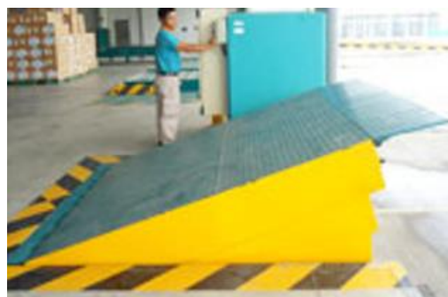
Bục nâng hạ tại truck dock của SCS
